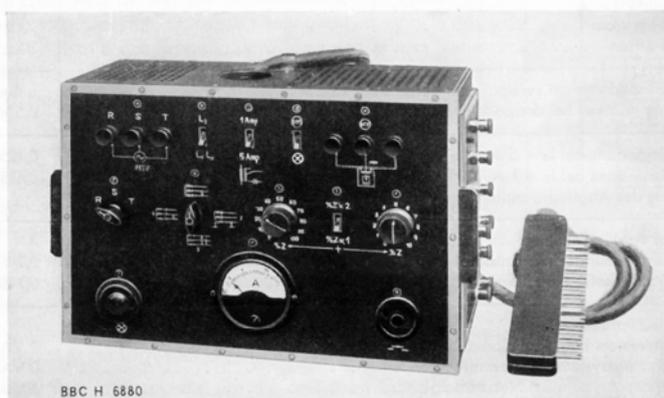
Abb. 9. Prüfgerät Bauart B für ein Schnellstanzrelais
